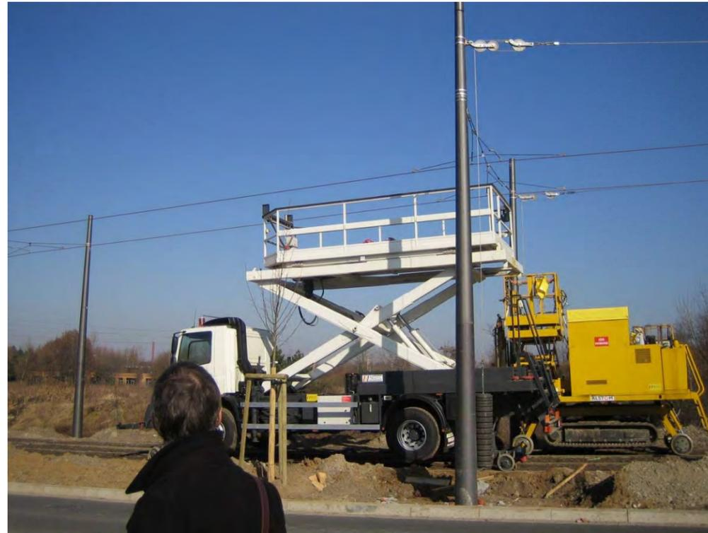
Figure 22 :Photo d'un camion « rail/route » avec nacelle de grandes dimensions
