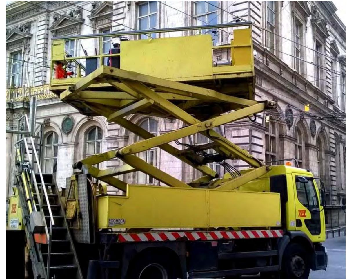
Figure 23 :Photo d'un camion « route » avec nacelle de grandes dimensions
